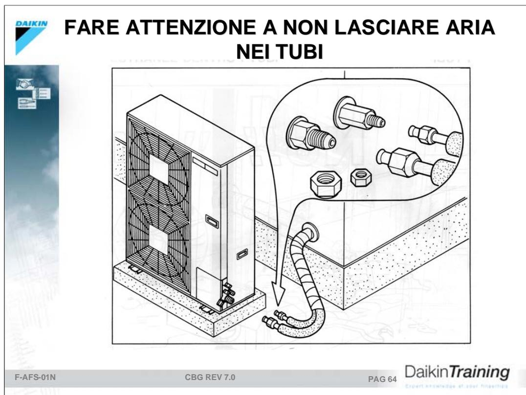
L'aria che è un "incondensabile" e l'acqua in essa contenuta sotto forma di umidità sono le maggiori cause di problemi in un impianto frigorifero. L'esecuzione del vuoto ha lo scopo di eliminare sia una che l'altra dal circuito e va sempre eseguita con la massima cura. E' bene ricordare che con basse temperature esterne, la rimozione dell'umidità è più difficile e perché avvenga occorre usare una pompa a doppio stadio, capace di raggiungere un buon livello di vuoto.
